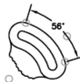
两线夹角：尺寸界线原点和尺寸线圆弧
